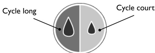
Par défaut en « **Cycle long** », l'appareil effectue 1s de pompage - 18 s de remplissage - 6s de pompage - 0.5s de remplissage. En « **Cycle court** », l'appareil effectue 1s de pompage (uniquement en réglage Max) - 13 s de remplissage - 6s de pompage - 0.5s de remplissage.
